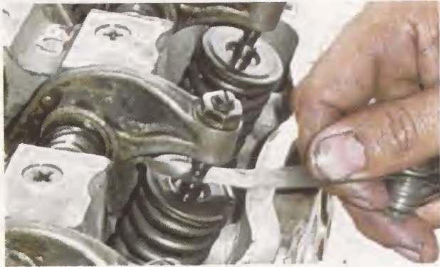
Ajuste de válvula con calibrador de galgas
